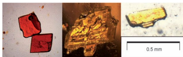
Abbildung 1. Lichtmikroskopische Aufnahmen der Kristalle der komplexen Nitrate (\text{NO})_2[\text{Pd}(\text{NO}_3)_4] (links), (\text{NO})[\text{Au}(\text{NO}_3)_4] (Mitte) und (\text{NO})_2[\text{Pt}(\text{NO}_3)_6] (rechts).
